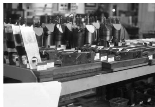
色分けされた組立機の治具。どこに戻すか一目で分かる
