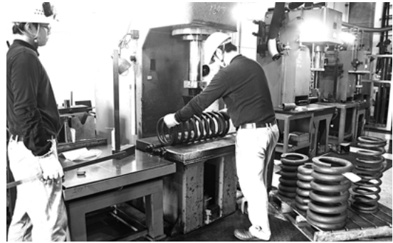
コイルばねのピッチを調整する
