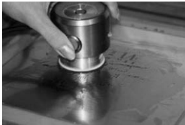
超音波振動を利用したハンディタイプの最初の洗浄器
