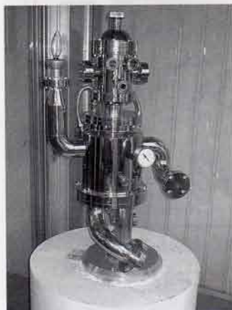
ステンレス加工技術を結集してつくったロボット形マスコット。頭は一体物素材からの削り出し、胴体は鍛造物からの切削加工、手足はパイプ加工、各種フランジも自社製品
