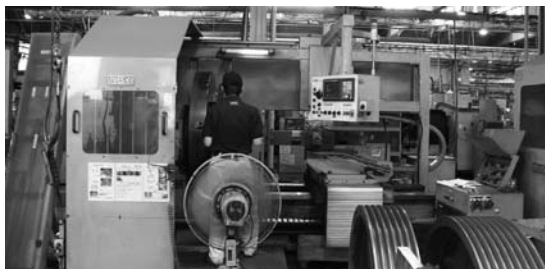
内製化された加工機はほとんど段取替えを必要としない
