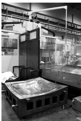
大型工作機によって削りだされた自動車ボディ金型
