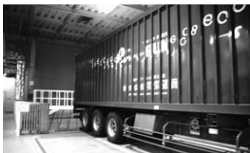
栗津工場のサイロに木質チップを搬入するトレーラー
