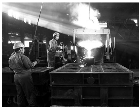
砂型に溶湯を注入する
