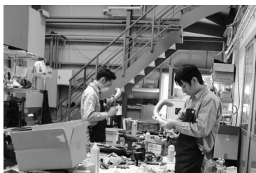
鋳造品の仕上げ工程
