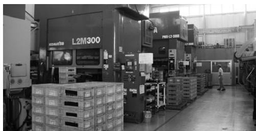
日本本社のプレス機。専用機として金型を付けっぱなしにしている
