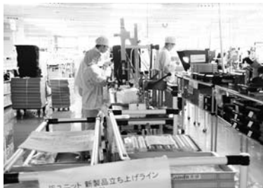
セル生産の現場
